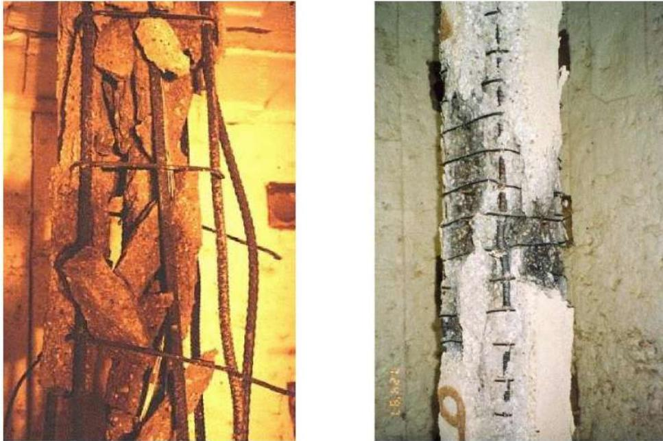
Figura 3: Comparación de la incidencia de la disposición de armaduras de confinamiento (estribos), convencional (izq.) y densificada (der.) (Kodur [7])
