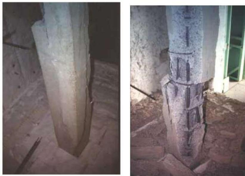
Figura 2: Comparación de descascaramiento entre hormigón normal (izquierda) y de alta resistencia (derecha) (Kodur y Sultan [7])
